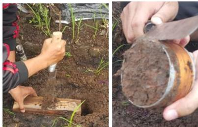
Gambar 3. Pengambilan Tanah dengan Ring Sampel
